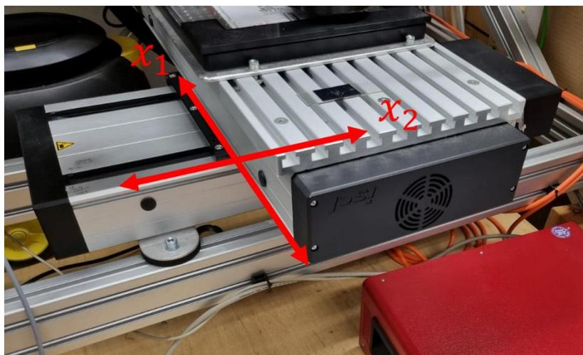
Abbildung 4-6: Kreuztisch mit Ausrichtung der beiden Achsen
