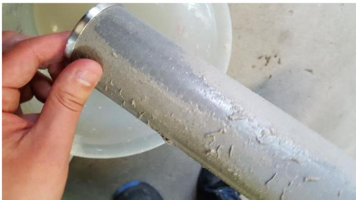
Abbildung 2-1: Filterkuchen auf der 150  $\mu\text{m}$ -Filterkerze bei der Abwasserprobenahme in einer Papierfabrik [12]
