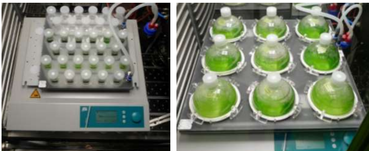
Abb. 4: Kultivierungsplattformen des Algenreaktorsystems. Links: Plattform mit 33 10-mL-Reaktoren. Rechts: Plattform mit neun 100-mL-Reaktoren.
