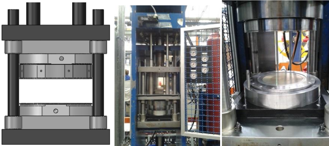
Abbildung 4-30: Versuchspresse des PtU. Links: schematische Darstellung; Mitte: Gesamtansicht; rechts: Werkzeugbaureaum.
