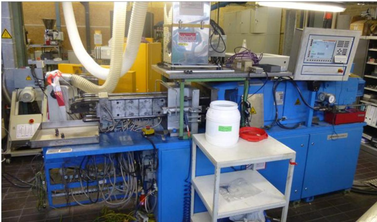
**Abbildung 57: Versuchsaufbau des Doppelschneckenextruders Coperion ZSK 32 am Fraunhofer-Institut, Darmstadt**
