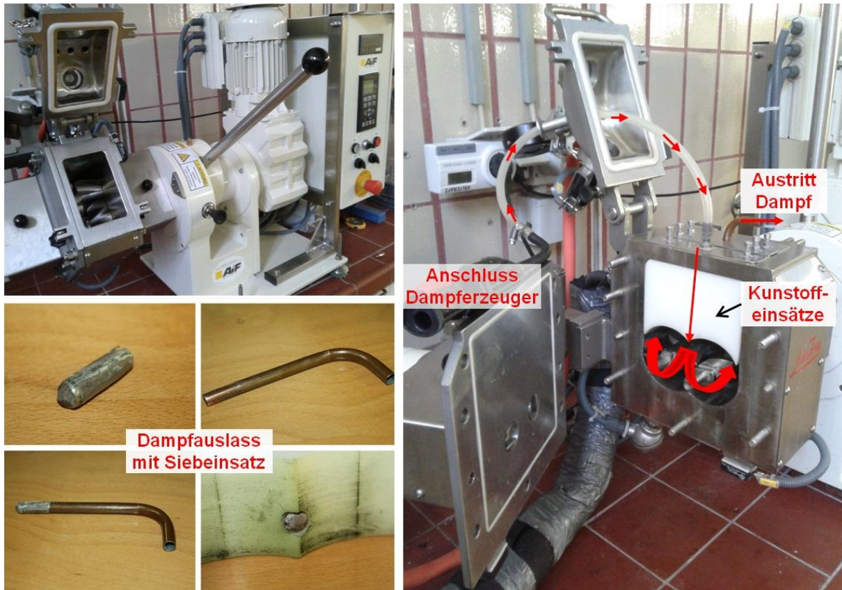
Abbildung 3.15: Aufbau und Funktionsweise der Dampfbehandlung eingedickter Faserstoffe im Knetzer
