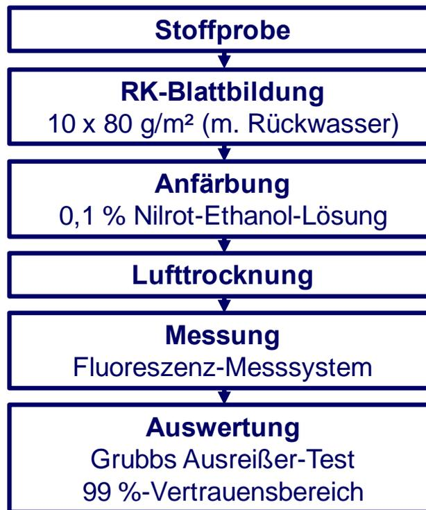
**Abbildung 5.20** Schematischer Ablauf der Messung mittels Fluoreszenz
