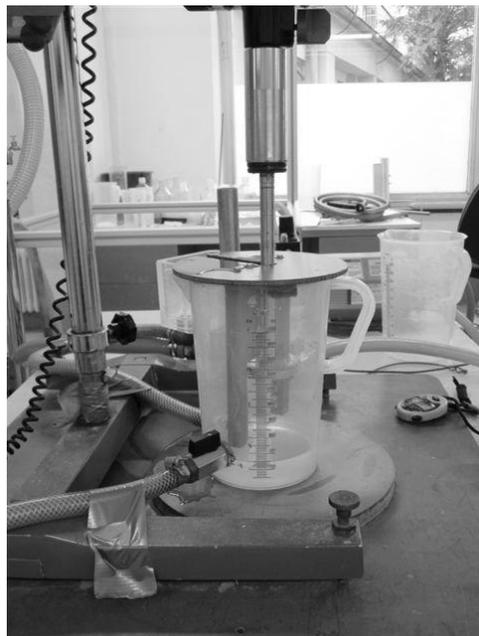
Abbildung 4.8: Detailansicht CGA-Generator der Laboranlage
