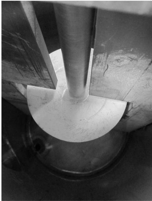
Abbildung 9.6: Innenansicht Schaumerzeuger der Pilotanlage
