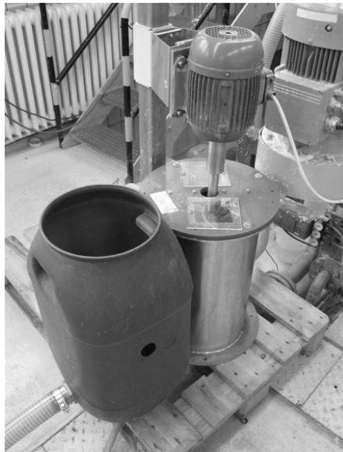
Abbildung 9.5: Detailansicht Schaumerzeuger und Flotationsanlage der Pilotanlage
