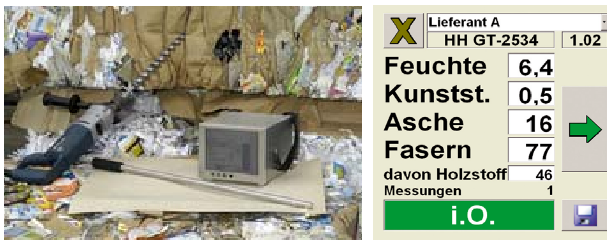
Abb. 5: PaperBaleSensor (PBS): links, Gerät vor Ort; rechts, Benutzeroberfläche des PBS
